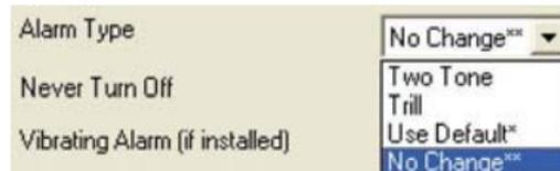
Lorsque le paramètre Never Turn Off est activé, l'instrument ne peut plus être éteint par l'utilisateur. Ce paramètre peut être activé, désactivé, défini sur le réglage usine ou laissé inchangé.
