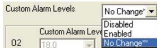
L'option **Custom Alarm Level (Niveau d'alarme personnalisé)** est une alarme définie par l'utilisateur de niveau supérieur à celui de l'alarme de danger. Elle peut être paramétrée pour chaque type de capteur. Les paramètres possibles sont **Disabled (Désactivée)**, **Enabled (Activée)** ou **No Change (Aucun changement)**.
