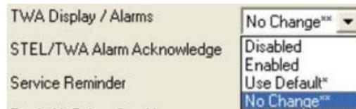
Le paramètre STEL/TWA Alarm Acknowledge (Acquittement des alarmes STEL/TWA) peut être activé, désactivé, défini sur le réglage usine ou laissé inchangé.
