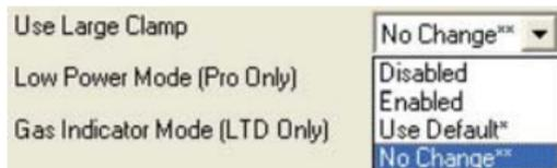
Le paramètre Low Power Mode (Mode économie d'énergie) peut être activé, désactivé, défini sur le réglage usine ou laissé inchangé.
