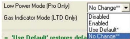
Le paramètre Gas Indicator Mode (Mode indicateur de gaz) peut être activé, désactivé, défini sur le réglage usine ou laissé inchangé.
