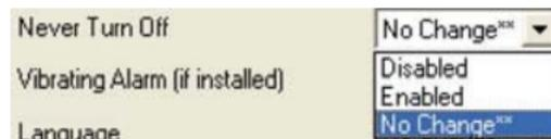
Si un instrument est doté d'une alarme vibrante, le paramètre Vibrating Alarm permet de l'activer, de la désactiver ou de conserver le réglage actuel.
