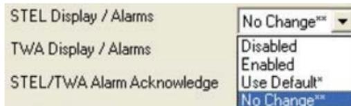
Le paramètre TWA Display/Alarms (Affichage/alarmes TWA) peut être activé, désactivé, défini sur le réglage usine ou laissé inchangé.
