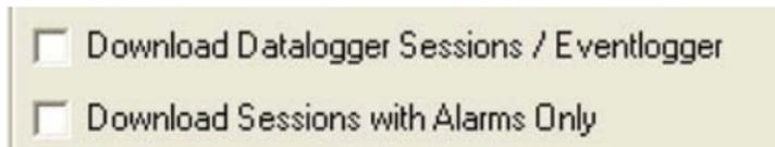
L'un des principaux atouts de l'IQ System réside dans sa capacité à gérer de gros volumes de données. Pour récupérer automatiquement des données provenant du détecteur lorsqu'il est connecté à l'IQ System, cochez la case Download Datalogger Sessions/Eventlogger. Si cette case n'est pas cochée, les données du détecteur ne seront pas récupérées et risquent d'être remplacées par les nouvelles données générées.
