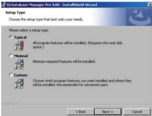
7. Honeywell Analytics recommande l'**installation classique** (Typical), mais les utilisateurs expérimentés sont libres de choisir une installation minimale ou personnalisée (Custom).
