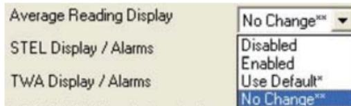
Le paramètre STEL Display/Alarms (Affichage/alarmes STEL) peut être activé, désactivé, défini sur le réglage usine ou laissé inchangé.
