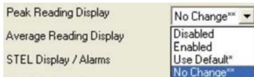
Le paramètre Average Reading Display (Affichage des mesures moyennes) peut être activé, désactivé, défini sur le réglage usine ou laissé inchangé.
