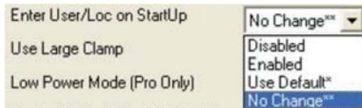
Le paramètre Use Large Clamp (Grande fixation) peut être activé, désactivé, défini sur le réglage usine ou laissé inchangé.
